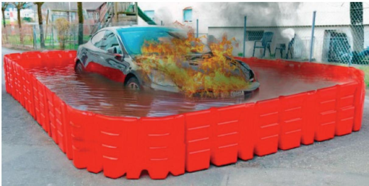
Les barrières à la clôture et les voitures électriques inondables sont une solution efficace et rapide pour éteindre les incendies de batteries au lithium. Avec la capacité à accumuler rapidement de grandes quantités d'eau, ces barrières sont essentielles pour limiter les dommages causés par ce type d'incendie. En outre, son assemblée est souple et simple, même avec seulement deux personnes.
